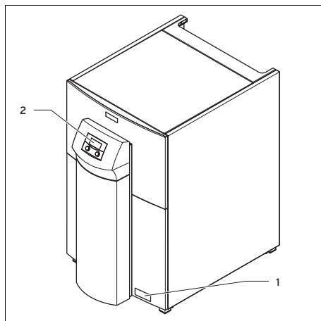
1 Наклейка с обозначением типа и серийным номером
