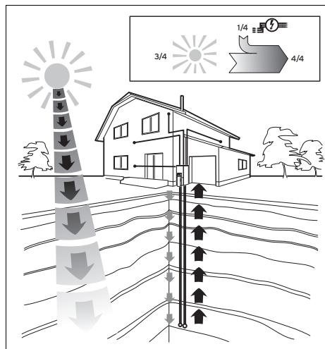
В качестве источника теплоты насос использует геотермическую энергию и работает по тому же принципу, что и холодильник. Тепловая энергия передается от среды с более высокой температурой к среде с более низкой и при этом отбирается у окружающей среды.
